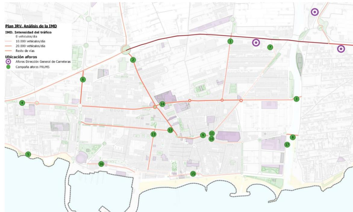
Ilustración 54. Ubicación de los aforos e IMD de las principales vías. Fuente. Elaboración propia
