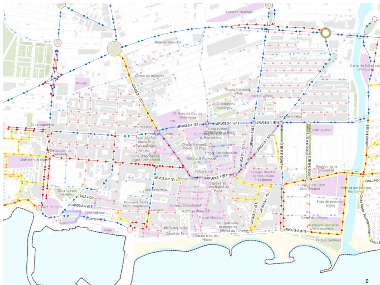
Ilustración 17. Reordenación de la zona del Casco Histórico. Modificación de sentidos de circulación y nuevos viales. Fuente. Elaboración propia
