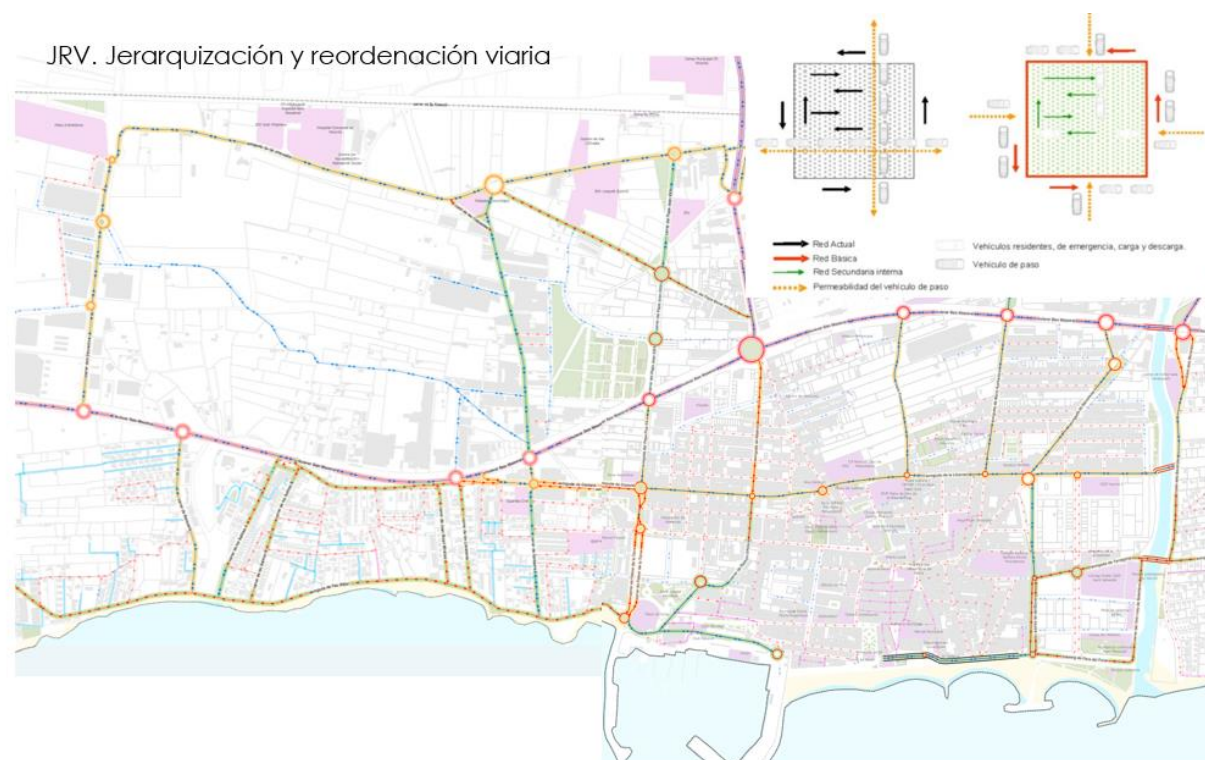
Ilustración 5. Jerarquía viaria propuesta para el escenario de corto plazo. Definición de las vías principales. Fuente: Elaboración propia
