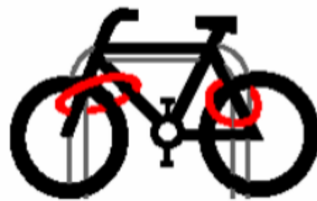
Ilustración 52. Candado de bicicleta a soporte en U-invertida. Fuente: Manual de aparcamientos de bicicletas del IDAE.
