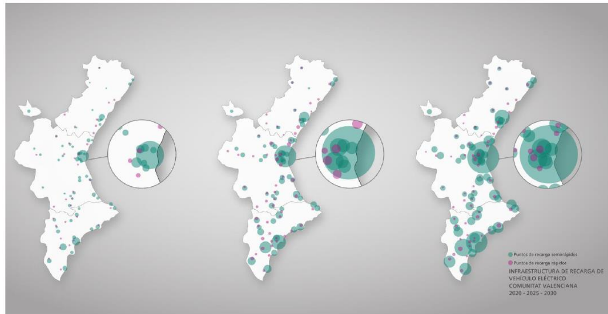
Ilustración 140 Distribución geográfica de los puntos de carga en la Comunitat Valenciana para 2020, 2025 y 2030. Fuente: IVACE
